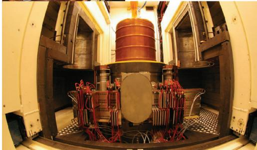
L'expérience est installée au Laboratoire Souterrain de Modane, à l'abri du rayonnement cosmique, sous les 1700m de roche du Mont Fréjus. Elle est construite en matériaux sélectionnés pour leur très basse radioactivité et protégée par des blindages. Les plus proches des détecteurs sont en plomb archéologique de l'époque romaine.
