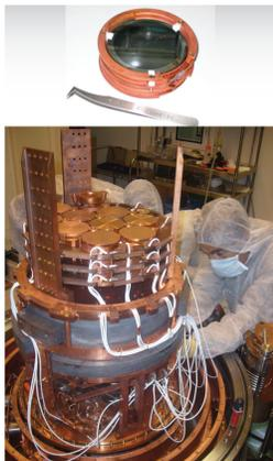
EDELWEISS met en oeuvre des détecteurs cryogéniques en Germanium à double détection, ionisation et chaleur, travaillant au voisinage du zéro absolu. Ils permettent de séparer le bruit de fond radioactif ambiant du signal des reculs de noyaux induits par les WIMPs, et donc d'accroître considérablement la sensibilité.
